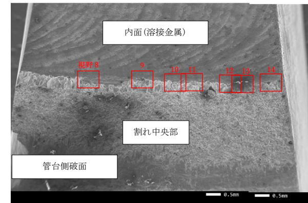
当該管 (T-2-2) の破面SEM (全体：管台側)
