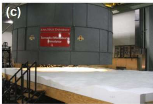
第 3-1 図 風洞実験の様子 (Karstens 2012)
