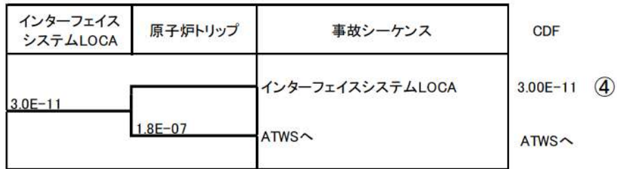
第4図 インターフェイスシステムLOCAのイベントツリー
