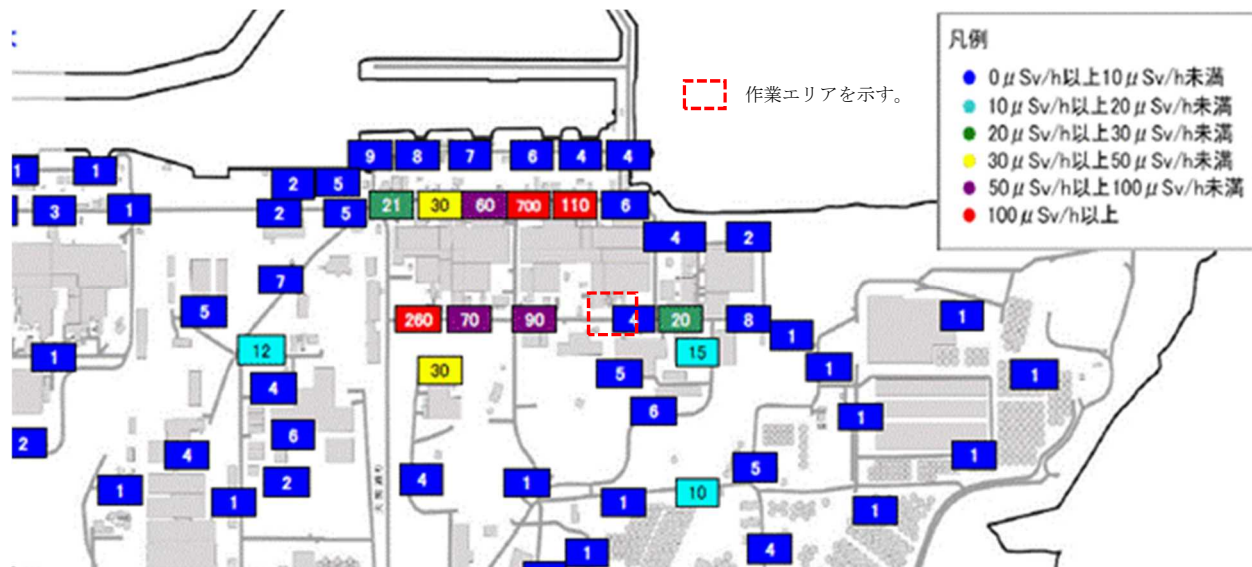
図1 作業エリア及び外部放射線量に係る線量率（2022年12月）
