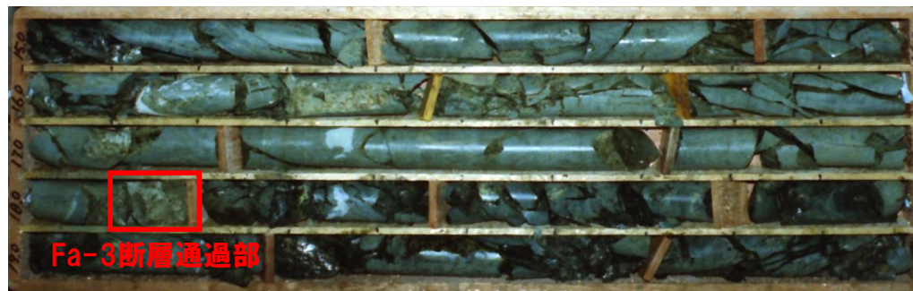
BH-42孔 コア写真 深度15m~20m (S58年 取得・撮影)
