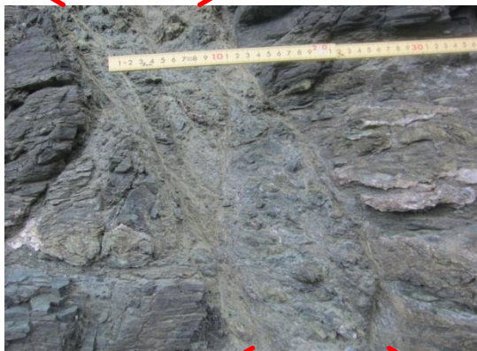
拡大写真② 破砕幅15~20cm程度
