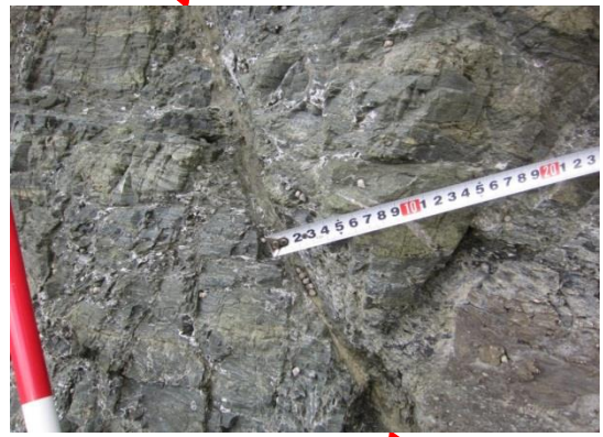
拡大写真③ 破砕幅1cm程度
