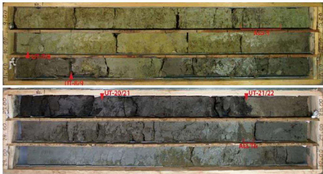
写真3 ボーリングコア写真。上：UT-7/8境界、UT-8/9境界および阿蘇3 (Aso-3) が認められる。下：UT-20/21境界、UT-21/22境界および阿多鳥浜 (Ata-Th) が認められる。撮影：柳田 誠。
