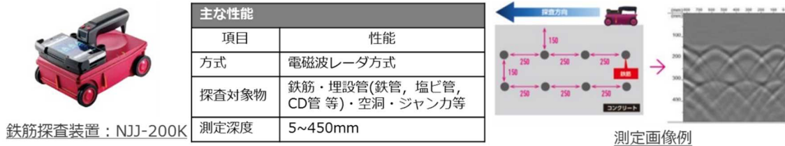
図 72 鉄筋探査装置
