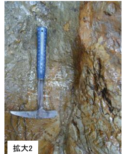
● 砂岩と泥岩の境界の断層面の連続性はやや不明瞭でしばしば分岐し、平面性は低い。また幅約5mmの砂礫岩を挟んでいるが、粘土状破碎部を伴わない。 ● 砂礫岩は、周囲の砂岩層と同様の固結の程度である。
