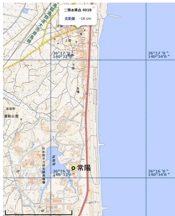
2011年東北地方太平洋沖地震に伴う地盤沈降量(国土地理院地図 地殻変動量)
