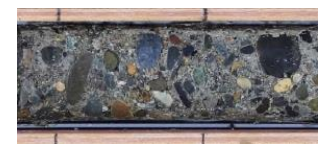
写真④ 東茨城層群の砂礫層。径5~30mmの亜円~円礫を主体とする。
