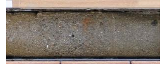
写真② M1 段丘堆積物は境界付近では10~15cm間隔で、細砂と礫混じり細砂が互層する。
