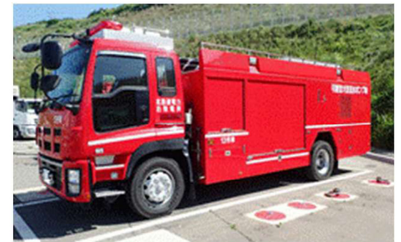
可搬型大型送水ポンプ車
