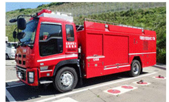
可搬型大型送水ポンプ車
