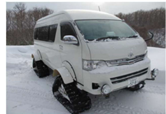
クローラー車 (最大登坂斜度: 30度, 最高速度: 60km/h)
