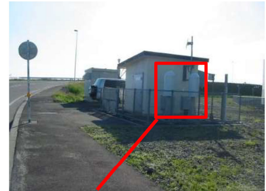
電離箱検出器及びNaI(Tl)シンチレーション検出器。防潮堤との距離は防潮堤に近い検出器で代表している。
