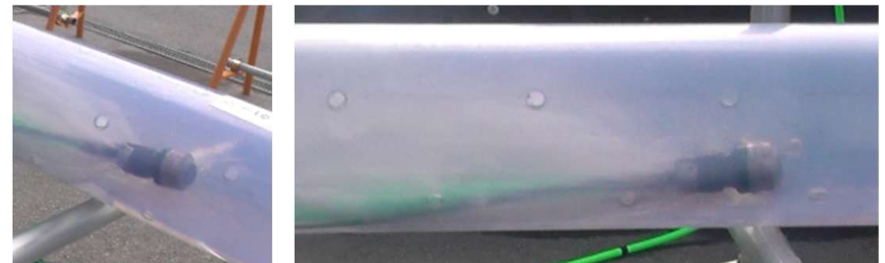
添付5-4(4)図 管内清掃装置進行時の様子
