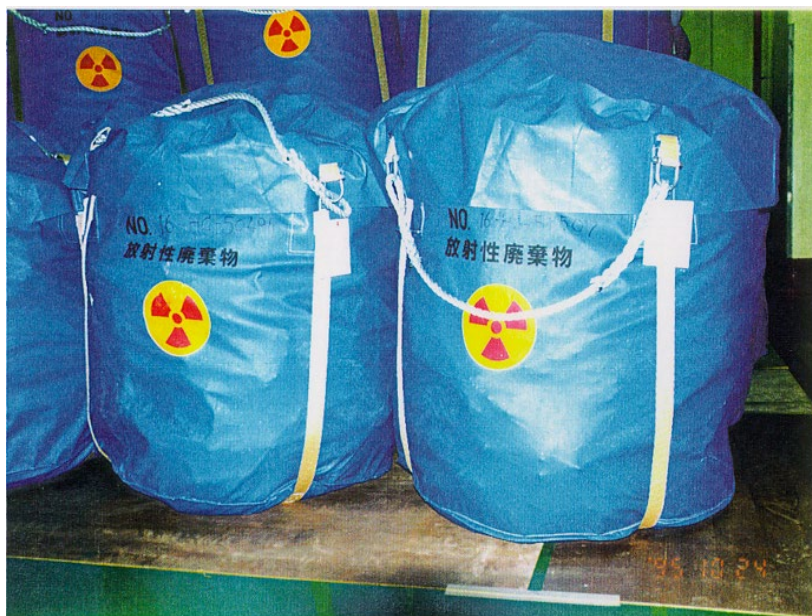
フレキシブルコンテナに収納した コンクリート廃棄物
