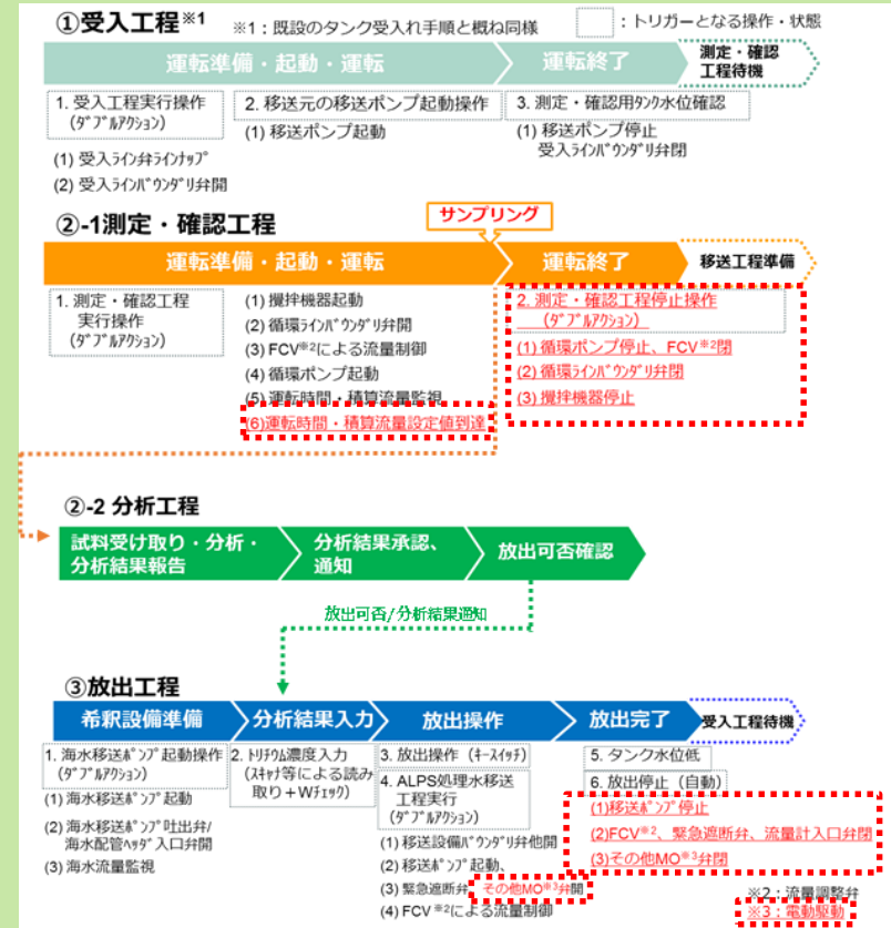
図-3 受入、測定・確認、放出工程の手順
