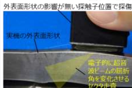
SCC付与モックアップでの探傷イメージ
