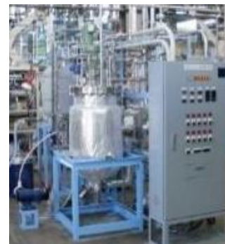
硝酸根分解試験装置 (1/25スケール)
