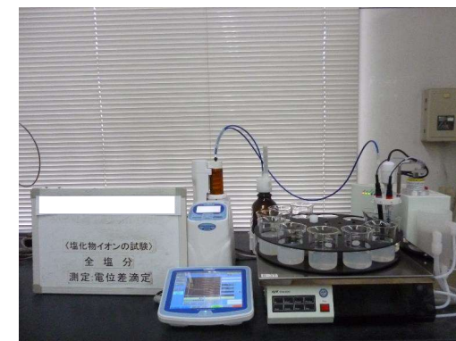
塩分浸透の点検状況 (塩化物イオン量の抽出状況)
