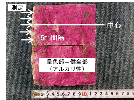
中性化深さの点検状況
