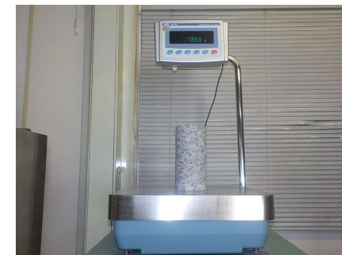
遮蔽能力の点検状況 (乾燥単位容積質量の測定状況)
