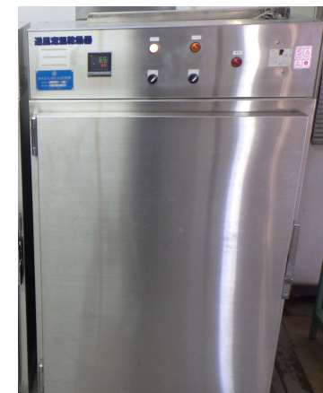
遮蔽能力の点検状況 (コアサンプルの乾燥状況)
