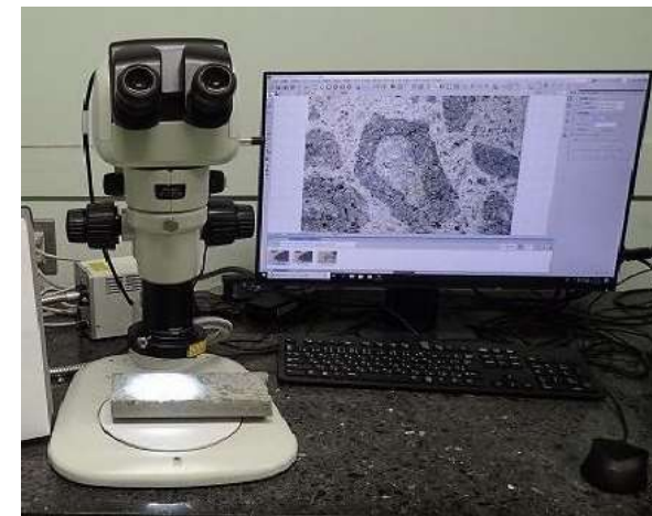
アルカリ骨材反応の点検状況 (実体顕微鏡観察の状況)
