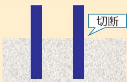
Step3 アンカーボルトを切断し，埋設部分以外を撤去する。
