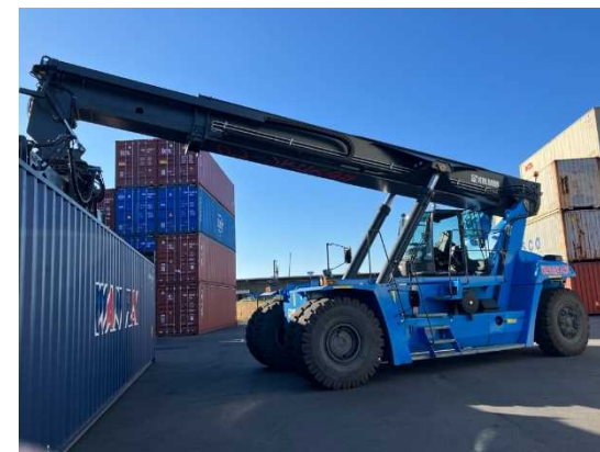
リーチスタッカー
