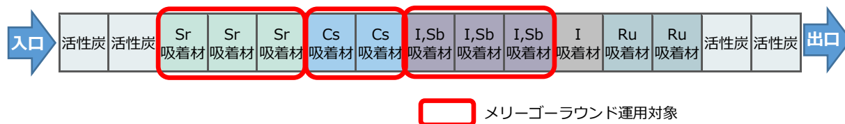
図 II-2 吸着塔構成の例（2018 年 9 月時点での例）
