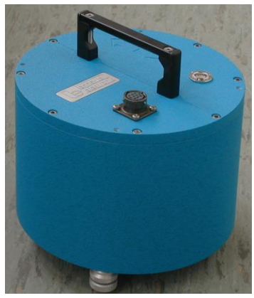
地震計LE-3D/5S レナーツ社 (独) http://www.lennartz-electronic.de/
