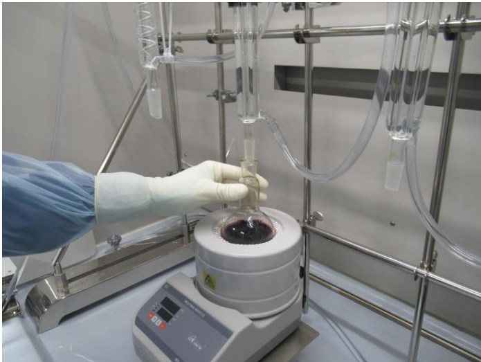
不純物（有機物）の除去装置を使用している様子
