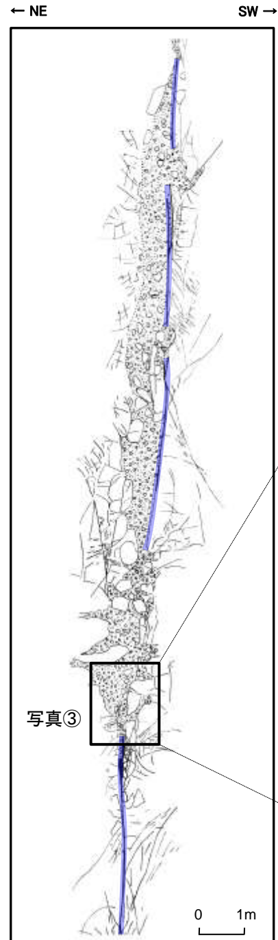
原子炉建屋底盤(EL-7.1m)に認められる S-1の詳細スケッチ
