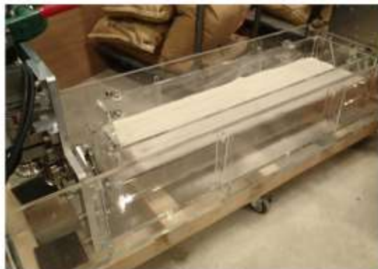
図-3 断層模型実験に用いたアクリル製の土槽（写真は水中用）
