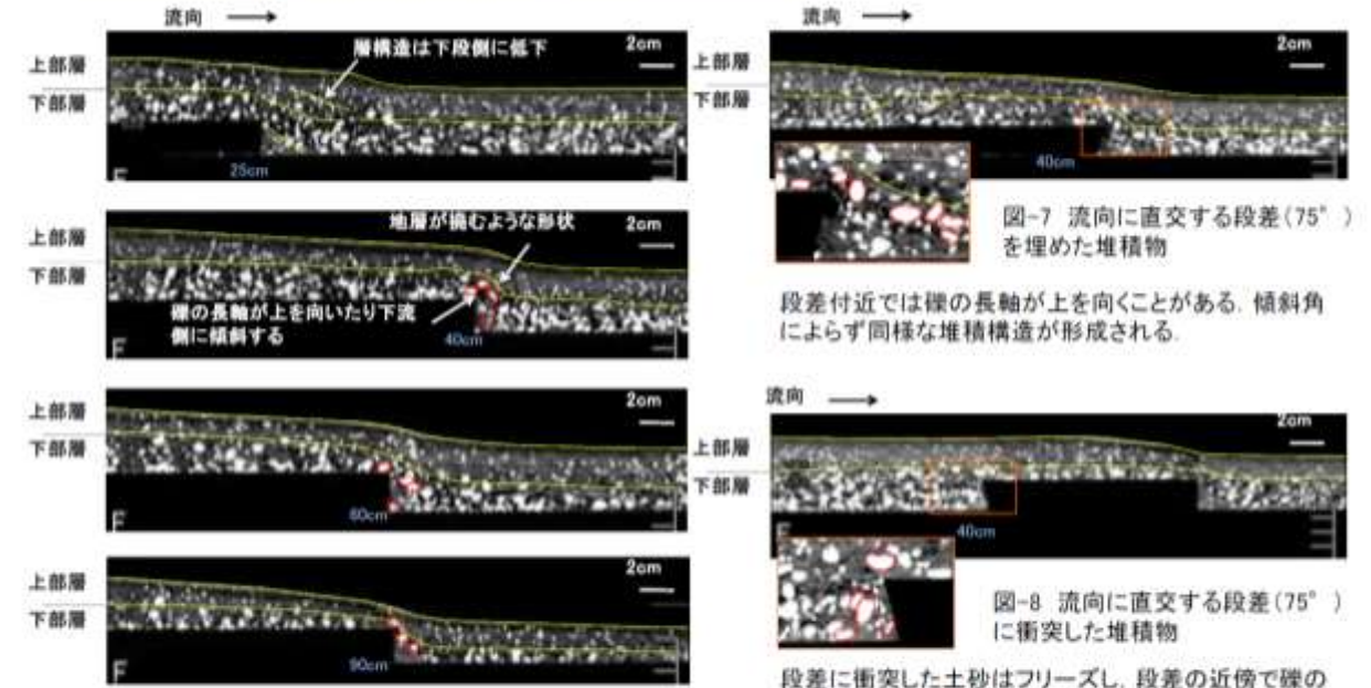
図-6 流向に直交する段差(90°)を埋めた堆積物。青字は勾配変化点からの距離
