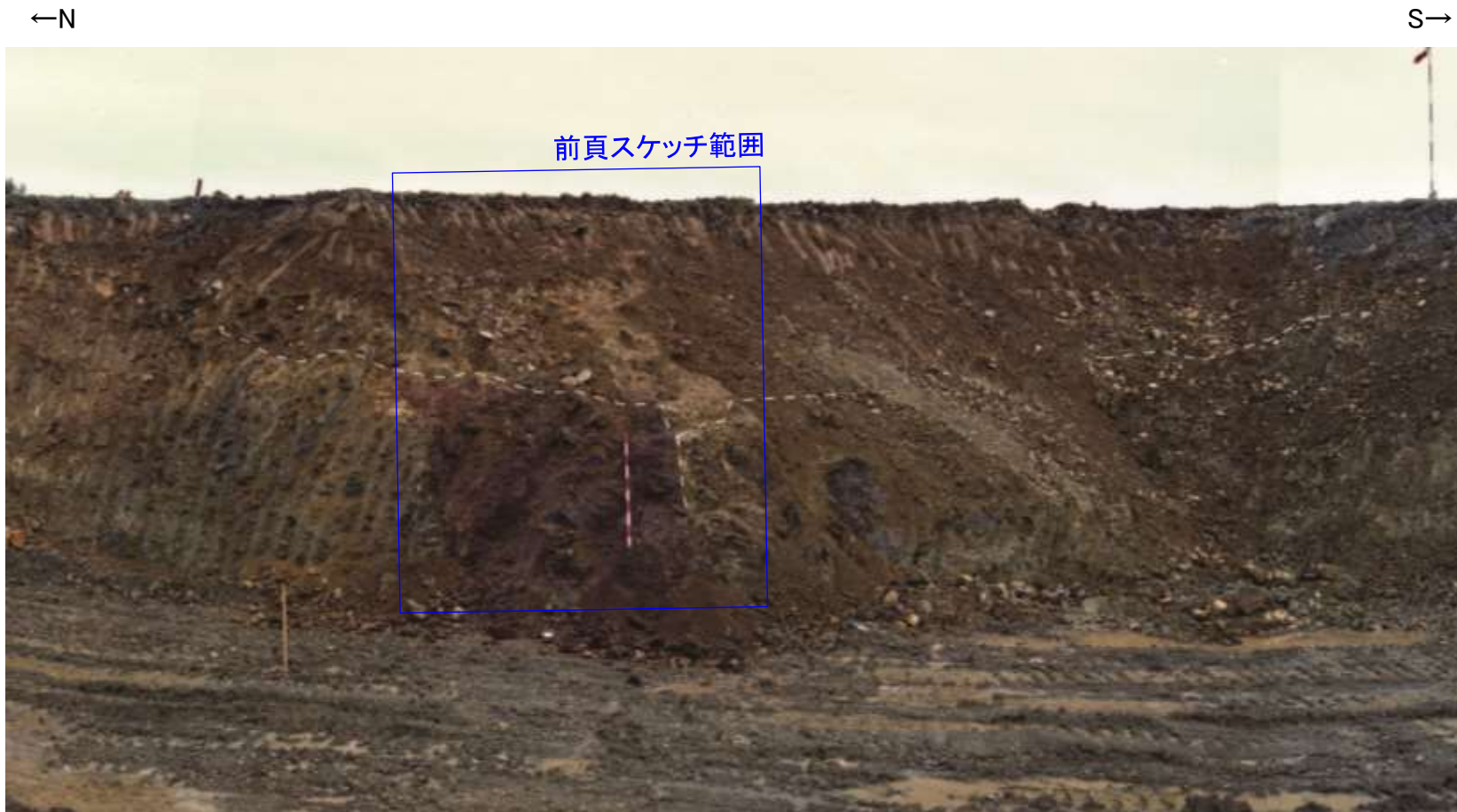
掘削法面 全景写真 (岩盤上面, S-1を白破線で加筆)
