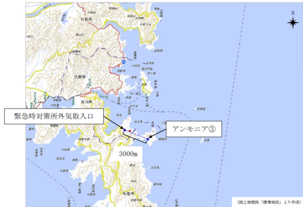
図13 アンモニア③と緊急時対策所外気取入口との距離の評価結果
