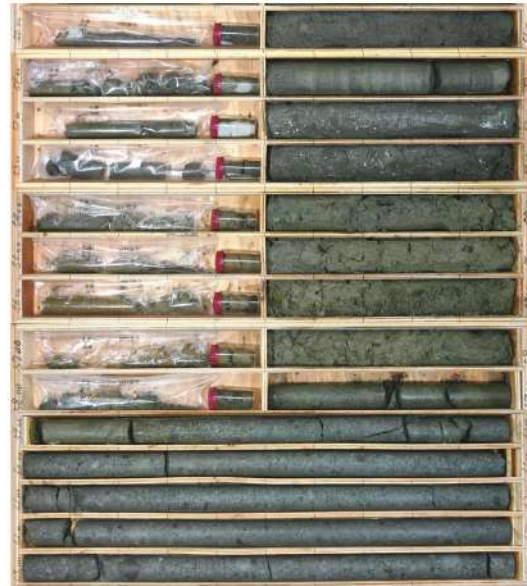
参考 1-32 図(3/3) ボーリング柱状図・コア写真 (U-1)
