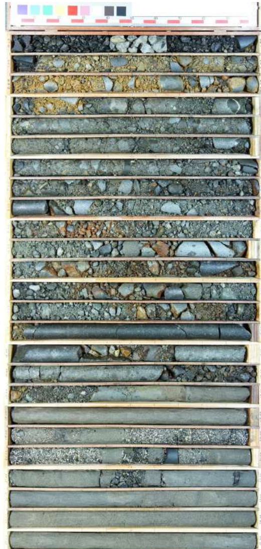
参考 1-9 図(1/3) ボーリング柱状図・コア写真 (RE-6)
