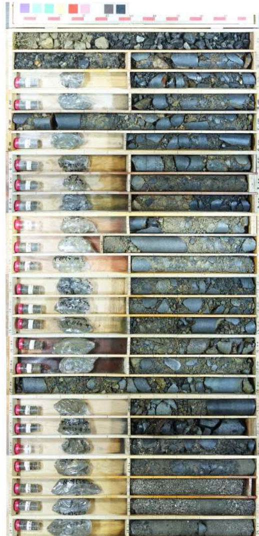
参考 1-25 図(1/3) ボーリング柱状図・コア写真 (SW2-1)
