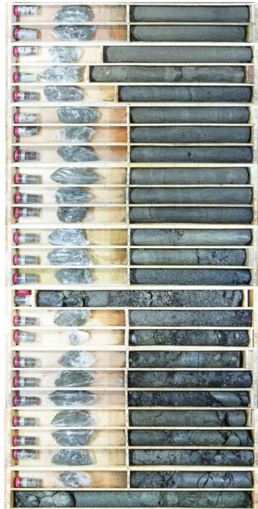
参考 1-47 図 (2/3) ボーリング柱状図・コア写真 (SW3-2)
