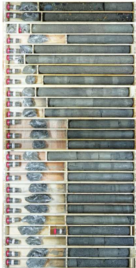
参考 1-45 図 (2/3) ボーリング柱状図・コア写真 (SW2-1)
