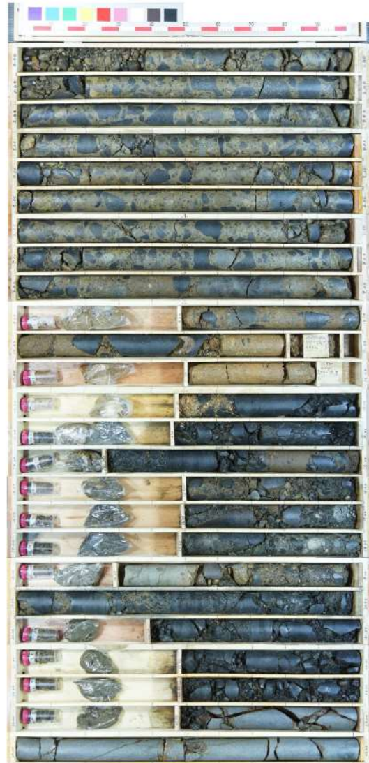
参考 1-27 図(1/2) ボーリング柱状図・コア写真 (BF3-2)
