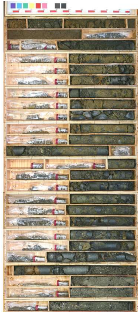
参考 1-41 図(1/3) ボーリング柱状図・コア写真 (U-1)
