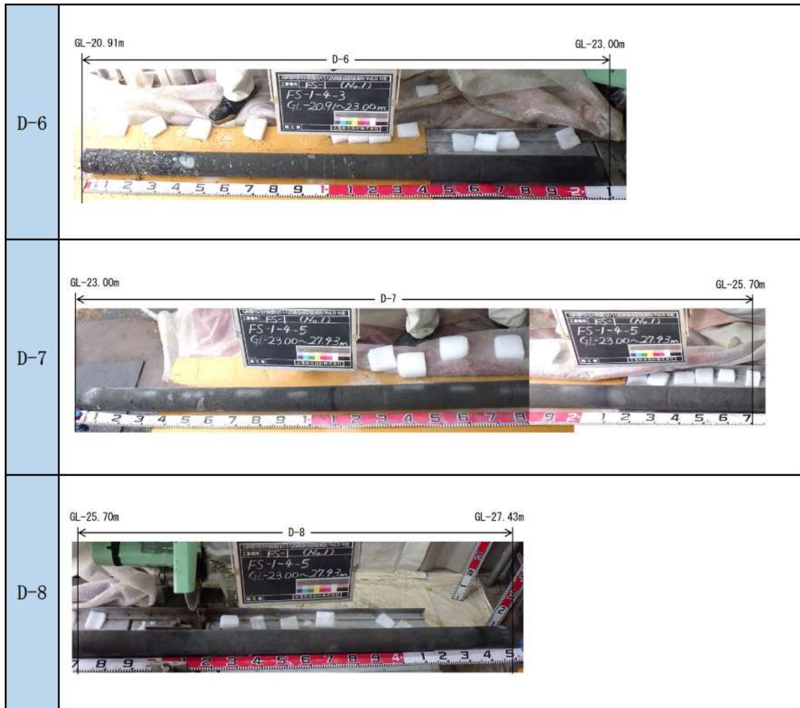
参考 1-24 図(10/10) ボーリング柱状図・コア写真 (FS-1)
