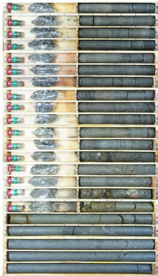
参考 1-46 図(3/3) ボーリング柱状図・コア写真 (SW3-1)
