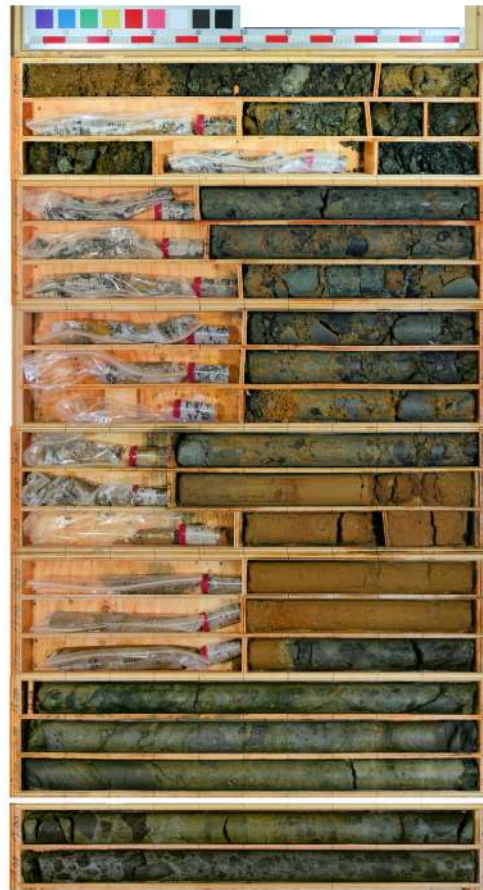
参考 1-16 図 ボーリング柱状図・コア写真 (U-8)
