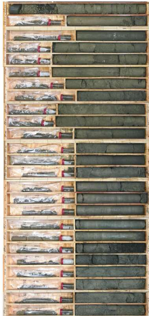
参考 1-32 図(2/3) ボーリング柱状図・コア写真 (U-1)
