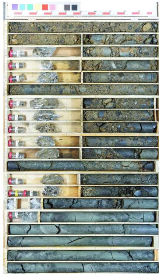
参考 1-1 図 ボーリング柱状図・コア写真 (SW2-3)
