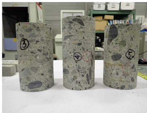
採取されたコンクリートコア
