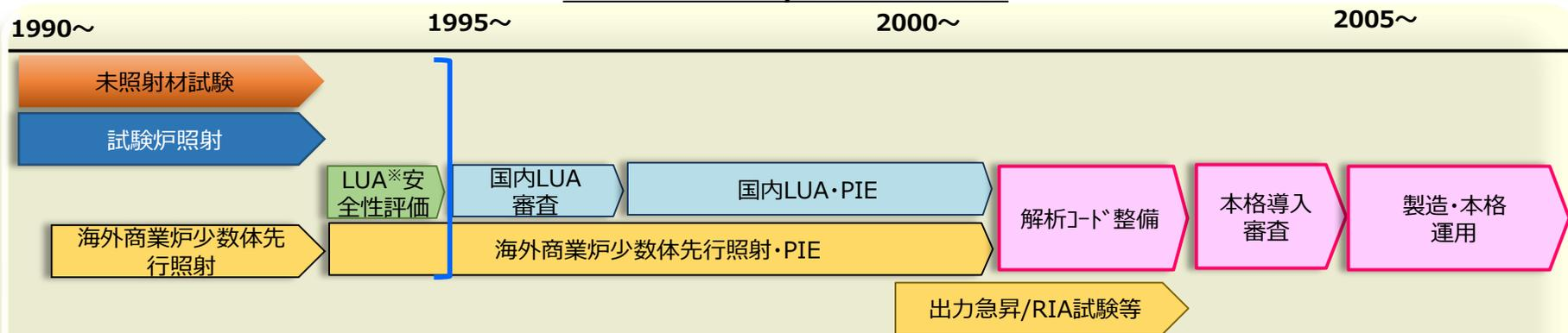
▼加圧水型原子炉高燃焼度化ステップ<sup>2</sup>
