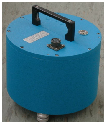
地震計LE-3D/5S レナーツ社 (独) http://www.lennartz-electronic.de/
