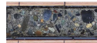
写真④ 東茨城層群の砂礫層。径5~30mmの垂円~円礫を主体とする。
