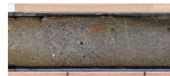
写真② M1 段丘堆積物は境界付近では10~15cm間隔で、細砂と礫混じり細砂が互層する。
