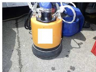
(a) 仮設ポンプ
