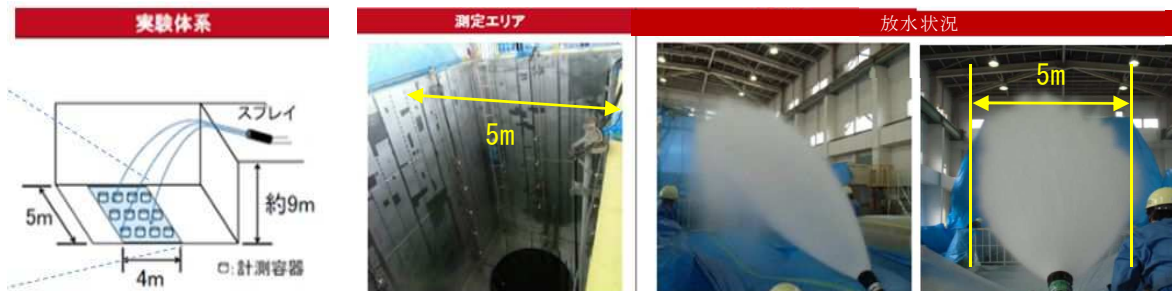
第1図 液滴径測定試験 試験体系及び試験の様子
