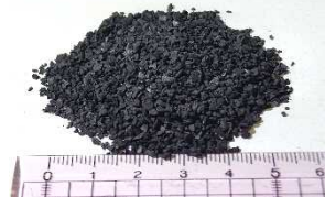
活性炭 (設置している物と同製品)
