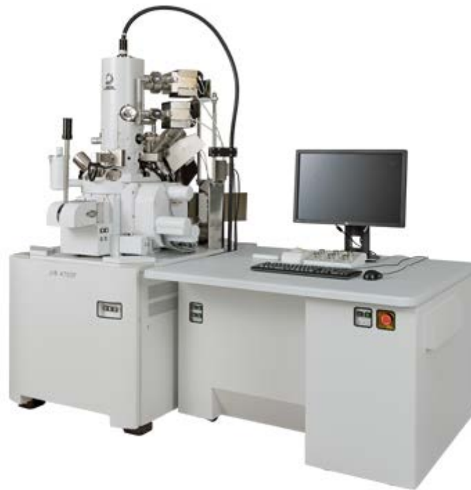
図 1 複合ビーム加工観察装置の外観(左側のユニットが装置本体、右側は操作観察部)
