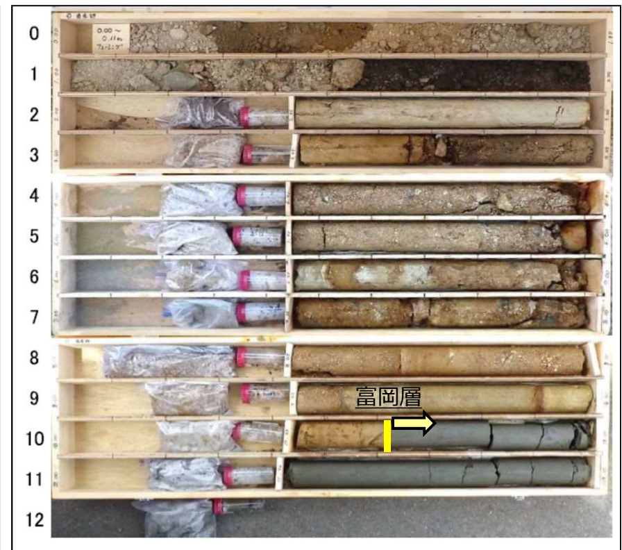
ボーリングコア
