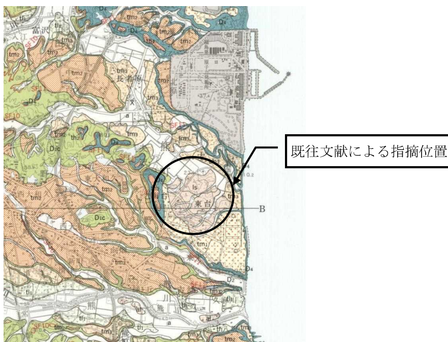
図-1 表層地すべりにより形成された可能性を指摘した緩斜面の位置 (既往文献より抜粋及び加筆)
