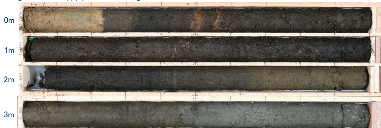
平沼地点における調査結果(ボーリングコア写真:3)
