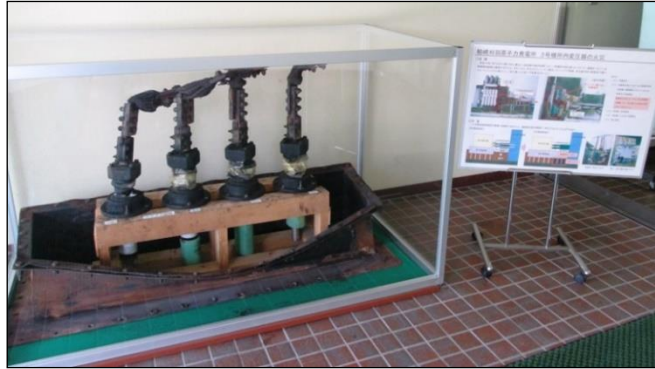
柏崎刈羽 3 号炉 所内変圧器の火災
