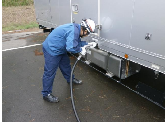
電源車への給油
