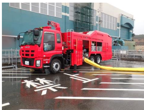
大容量送水車（熱交換器ユニット用）
