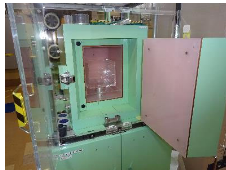
放射能測定装置の例 (Ge半導体検出器)
