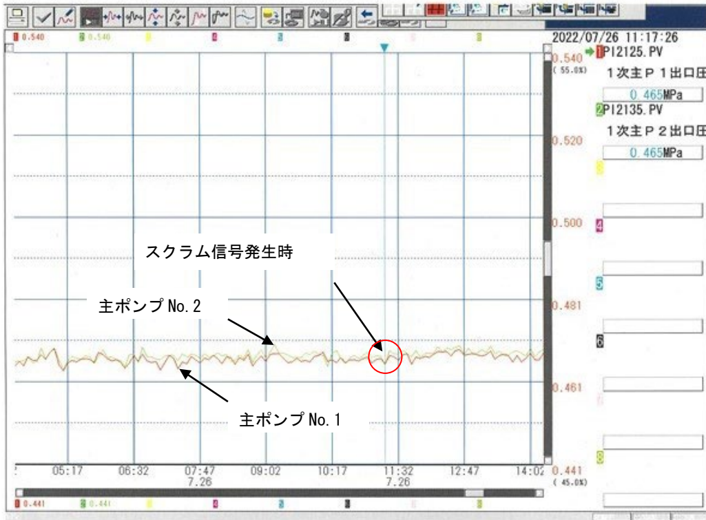
1次冷却材主ポンプ出口圧力 (No. 1、No. 2) (5分トレンド)
