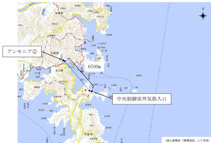
図8 アンモニア②と中央制御室外気取入口との距離の評価結果
