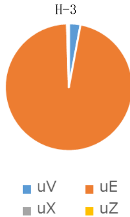
図 3.1.4-27 低バック液体シンチレーション計数装置によるトリチウム放射能濃度の不確かさ要因と評価結果
