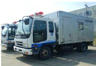
高圧電源車 ・容量:300kVA
