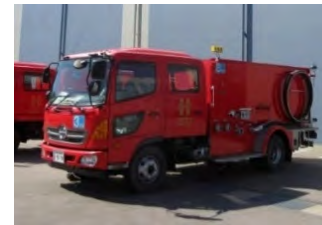
可搬型代替低圧ポンプ ・吐出量:120m 3 /h
