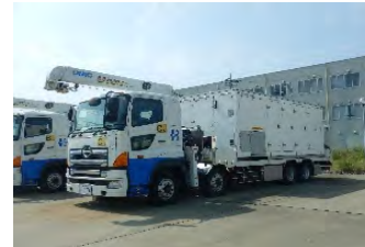
可搬型代替海水ポンプ ・吐出量:1440m 3 /h
