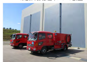
可搬型代替低圧ポンプの配備
