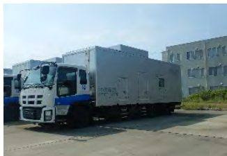
低圧電源車 ・容量:1100kVA
