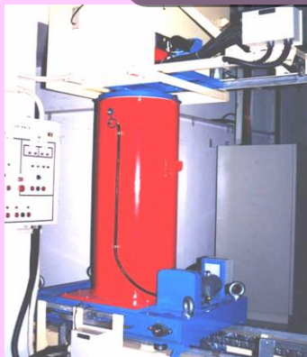
プルトニウム キャニスタ測定 システム (PCAS: Plutonium Canister Assay System)
