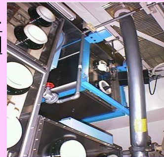
改良型グローブボックス測定システム (SBAS: Hold-up Assay System)
