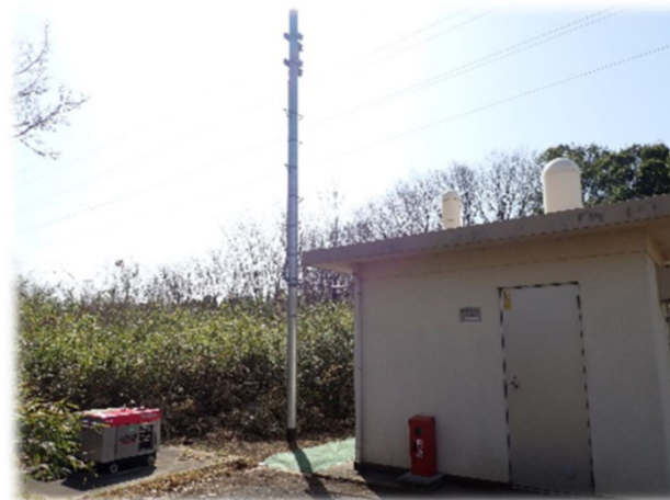
環境放射線モニタリング (モニタリングポストによる連続監視)
