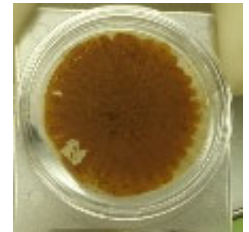
原子炉建屋底部から回収した汚泥
