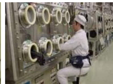
地下環境を模擬したグローブボックス内における放射性物質移行データの取得
