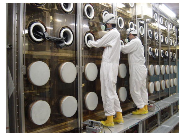
グローブボックスの中でプルトニウム等を取扱う
